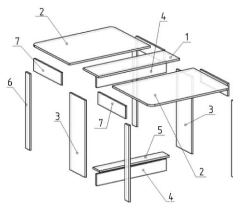
Рисунок 2 – Схема крепления рояльной петли
