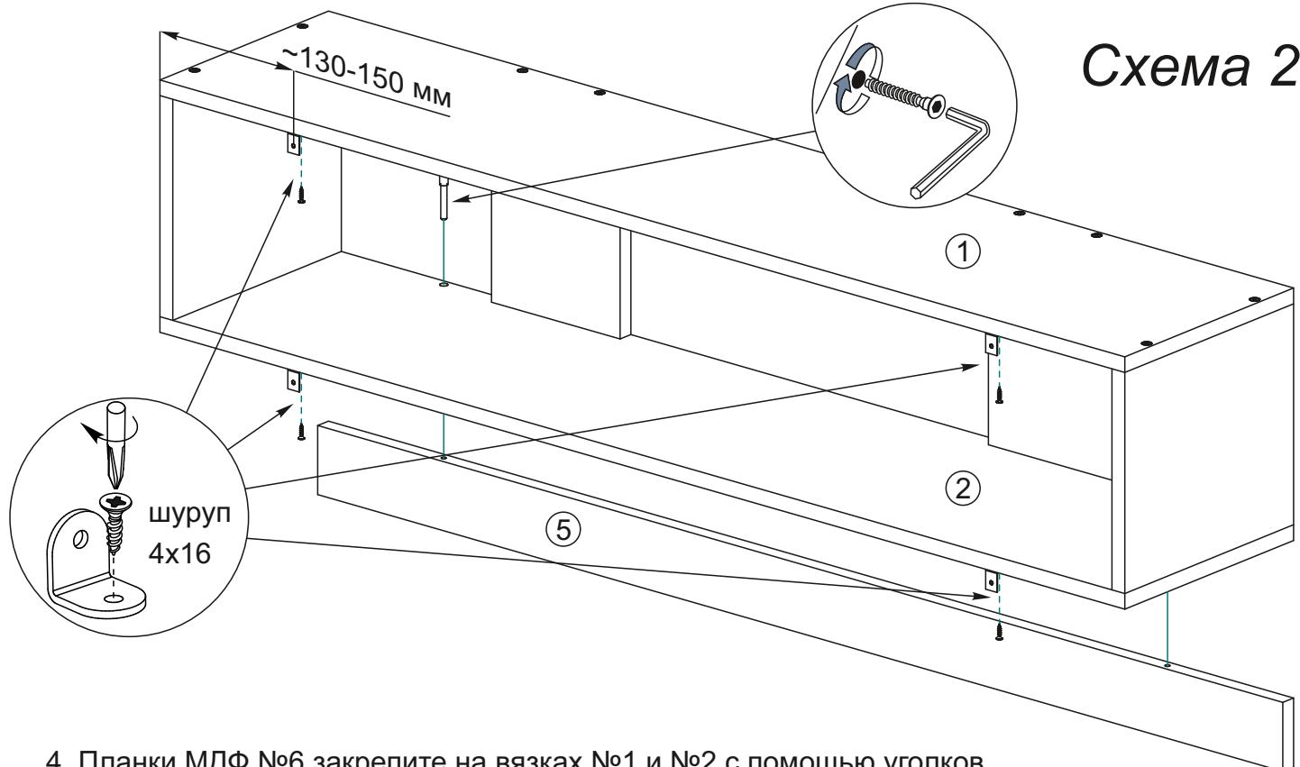
4. Планки МДФ №6 закрепите на вязках №1 и №2 с помощью уголков 20x20 и шурупов 4x16. На задние стенки №4 закрепите навесы плоские шурупами 4x16, как показано на схеме 3.
