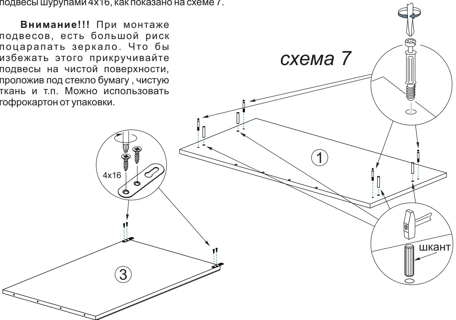
9. Скрепите между собой евровинтами детали №1 и №3. Далее крышку №1 соедините с помощью эксцентриковой стяжки с собранной ранее конструкцией. При этом подвесы, установленные на детали №3, крепятся к стене. Крепеж для фиксации подвесов к стене в комплект фурнитуры не входит.
