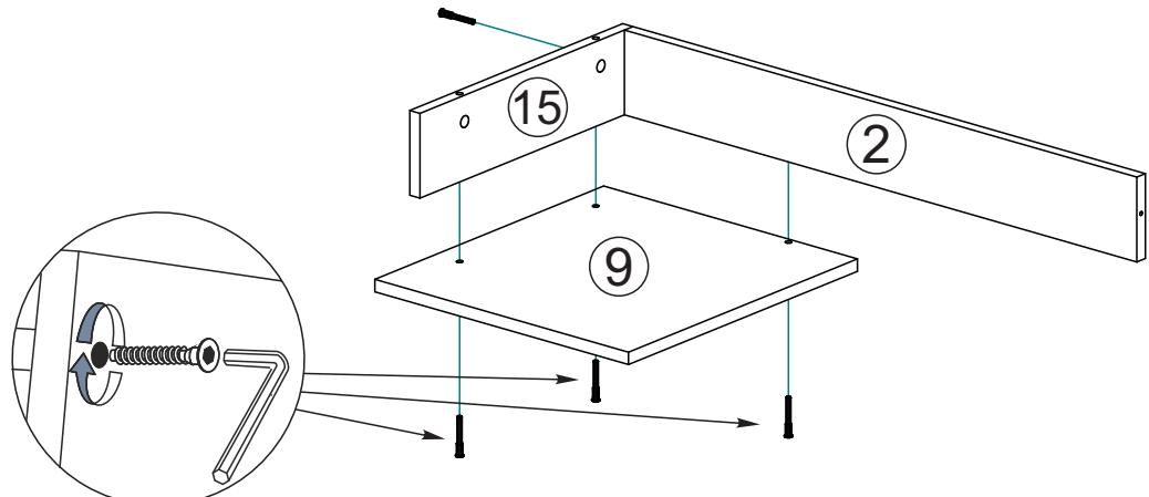
6. Затем соедините крышку №9 с прикрученными деталями №2 и №15 с собранным ранее коробом. Для этого через планки № 11 закрутите шурупы 4x25 в крышку №9, как показано на схеме 5.
