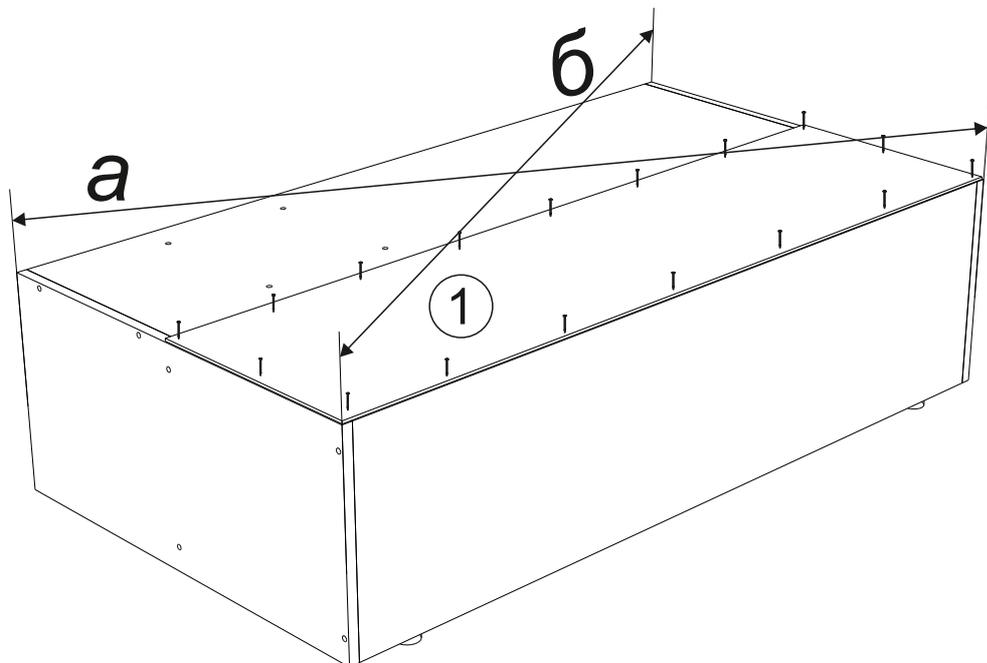
4. Прибейте к деталям №2 и №3 пластиковые подпятники, затем с помощью уголков 20x20 и шурупов 4x16 закрепите между собой цоколи, проверьте и уровняйте диагонали собранной конструкции как показано на схеме 3.
