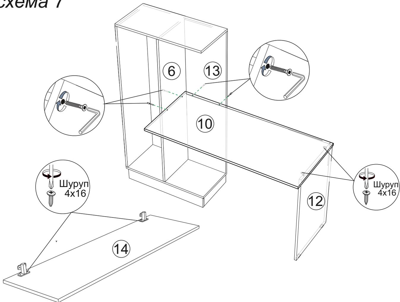
9. Закрепите створку №14 в ответные планки петель на боковине, зафиксируйте винты отрегулируйте и выставьте зазоры согласно схеме. Закрепите ручку с помощью шурупов 3,5x30. Установите полки №11 как показано на схеме 8.
