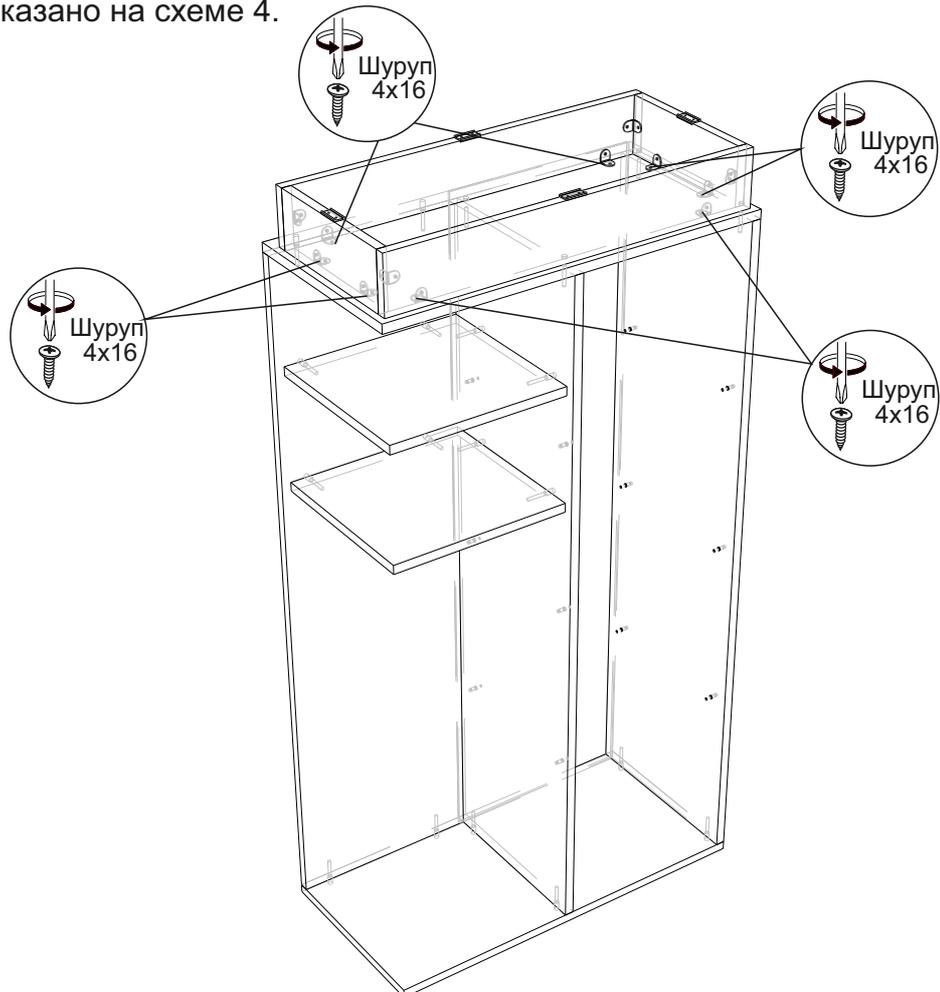
6. Закрепите между собой царгу №4 и боковину №12 с помощью евровинтов, закрепите к боковине №12 уголки 20x20 шурупами 4x16, прибейте к боковине №12 пластиковые подпятники как показано на схеме 5.
