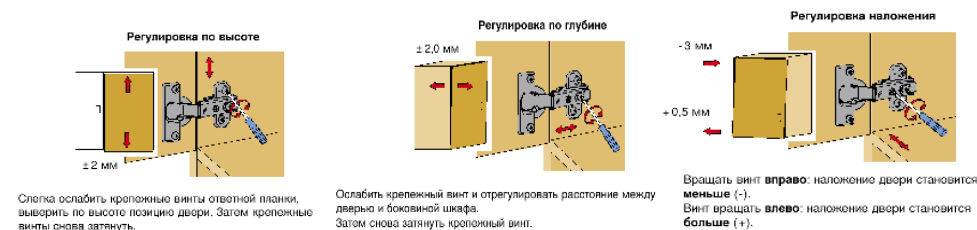
Рис.2 Схема установки петель
