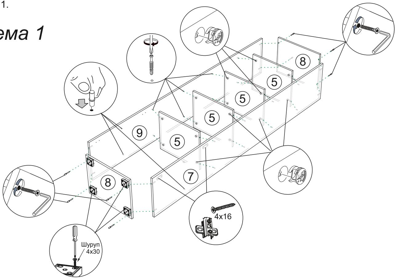
3. Чтобы установить задние стенки №1, №2, №3, №4 необходимо собранную конструкцию перевернуть лицевой стороной вниз. Замерить, с помощью рулетки, и уравнять диагонали ( $a=b$ ). Наложите задние стенки соедините профилем и аккуратно, не нарушая диагоналей, прибейте ЛДВП гвоздями с шагом 130-150мм как показано на схеме 2.
