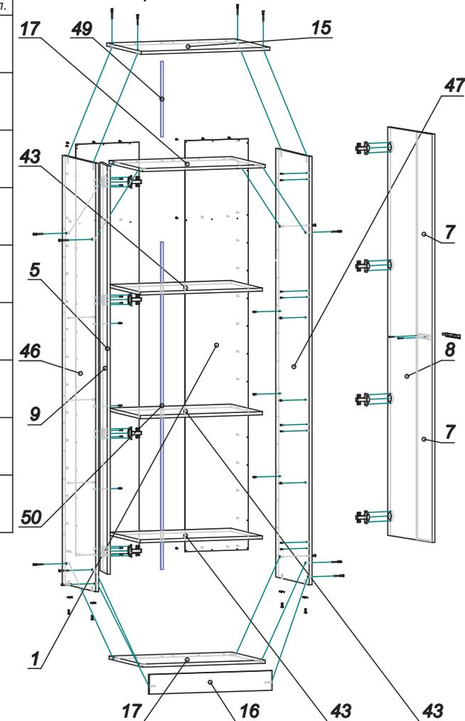
схема установки соединительного профиля
